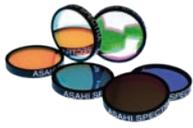
単色光照射用の狭帯域バンドパスフィルターです。ミラーモジュールと併用します。
